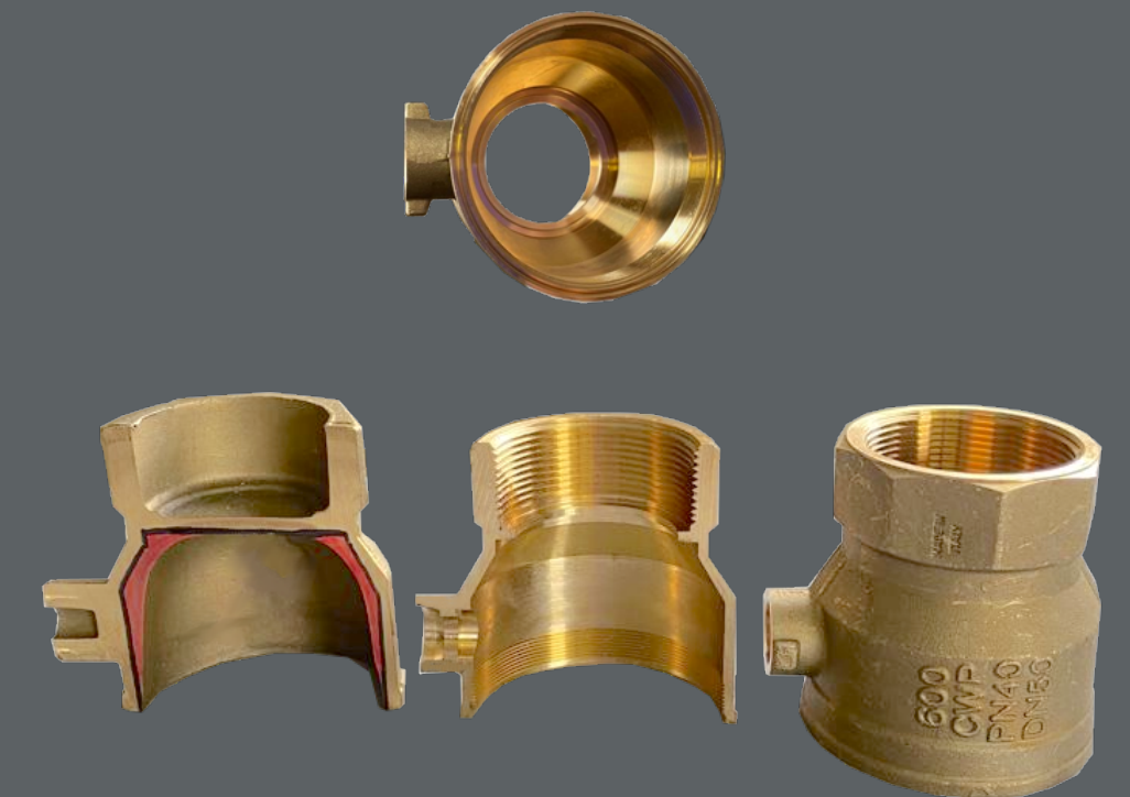
Corps de vanne 2" CW511L Temps de cycle: 17 s.
